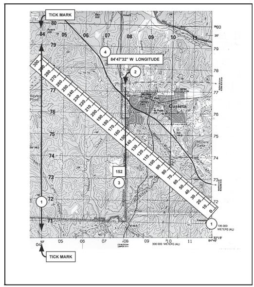
Figure 4-5. Determining longitude
