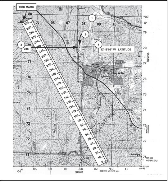
Figure 4-4. Determining latitude
